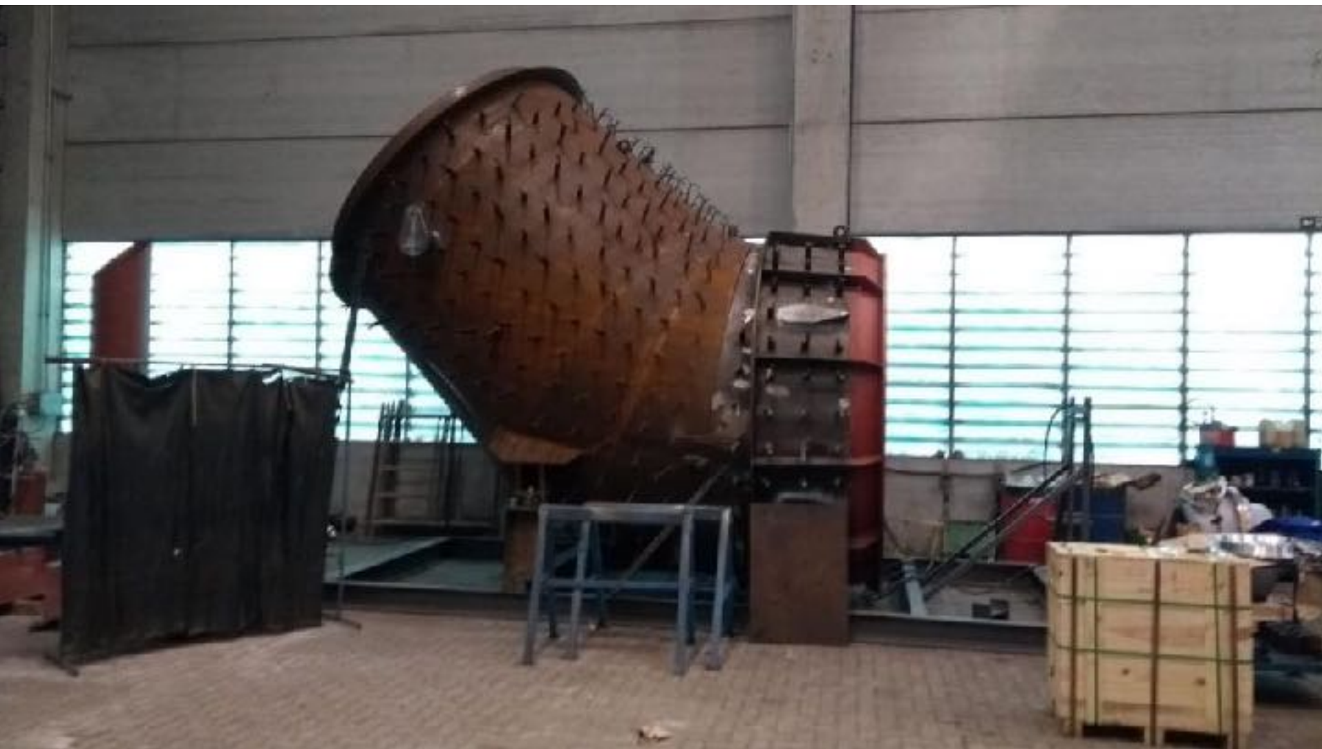
TURBINA M2 EM FASE DE MONTAGEM
